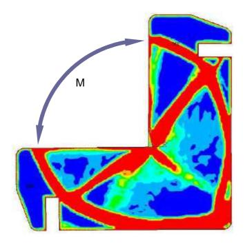
Zwei dimensionale Optimierung von Profilen (z. B. Strangpressprofile)
